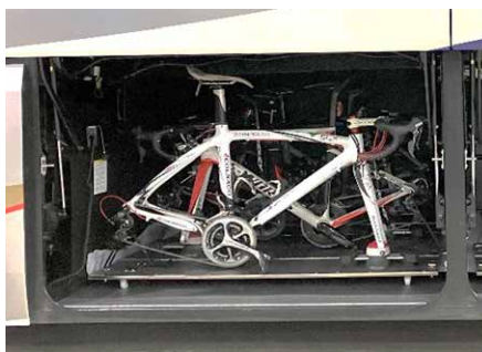
トランクルーム内への搭載（車輪を取り外し、自転車フレームを台車に取付）
