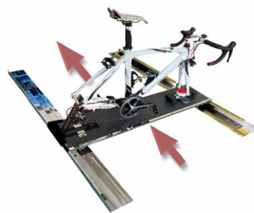
トランクルーム内への搭載（車輪を取り外し、自転車フレームを台車に取付）
