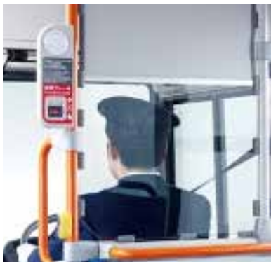
車内の非常ブレーキスイッチ
